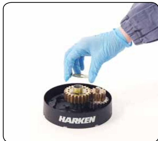
11. Remove the washer n°12
