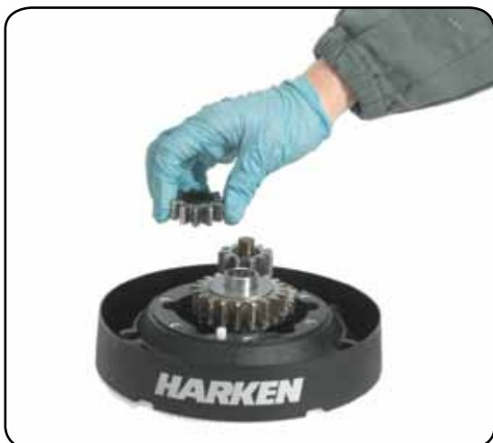
10. Remove the gear n°15
