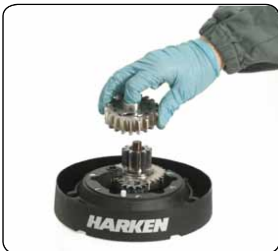
12. Remove the gear n°10 and remove the pawls carrier n°7.
