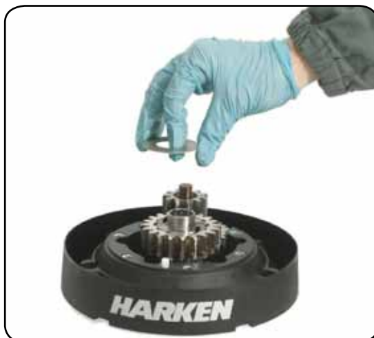
11. Remove the washer n°14
