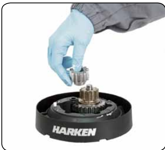
13. Remove the gear n°3
