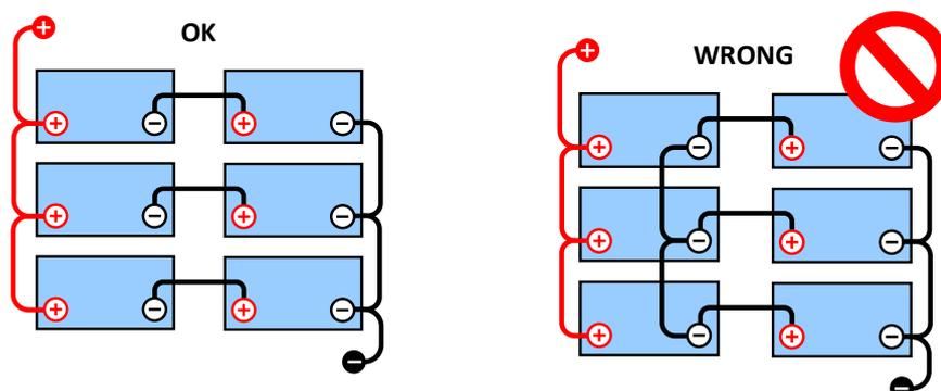
En raison de la chute de tension sur les câbles positif et négatif, la tension du point médian n'est pas identique.
