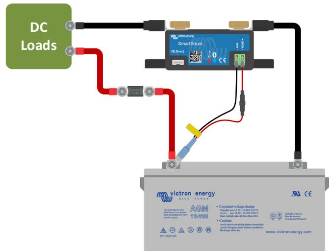
Se usar o sensor de temperatura, os cabos elétricos vermelhos incluídos com o SmartShunt não são necessários. O sensor de temperatura vai substituir estes cabos.
