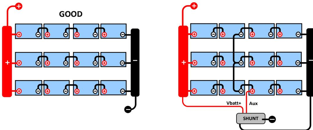
In einer unüberwachten Batteriebank sollten die Mittelpunkte nicht miteinander verbunden sein, eine schlechte Batteriebank kann unbemerkt bleiben und alle anderen Batterien beschädigen.
