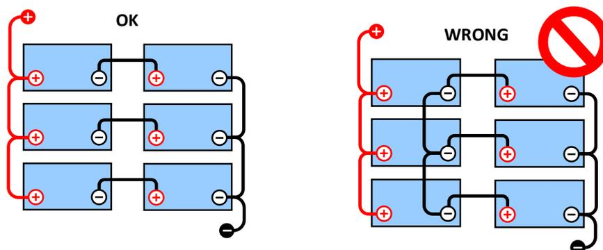
Aufgrund des Spannungsabfalls über das positive und das negative Kabel sind die Mittenspannungen nicht identisch.
