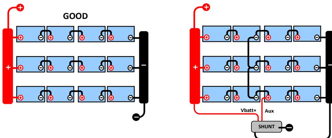
I en oövervakad batteribank bör inte mittzonerna länkas samman, en dålig batteribank kan missas och skada alla de andra batterierna.
