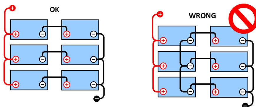
In seguito alla caduta di tensione sui cavi positivo e negativo, le tensioni del punto medio non sono uguali.
