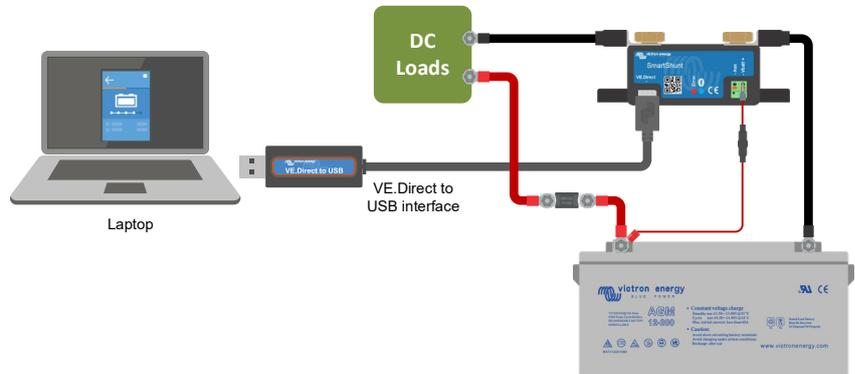
För att ansluta via USB behöver du ett VE.Direct till USB-gränssnitt, delnummer SS030530000. Använd det gränssnittet för att ansluta datorn till SmartShunten.
