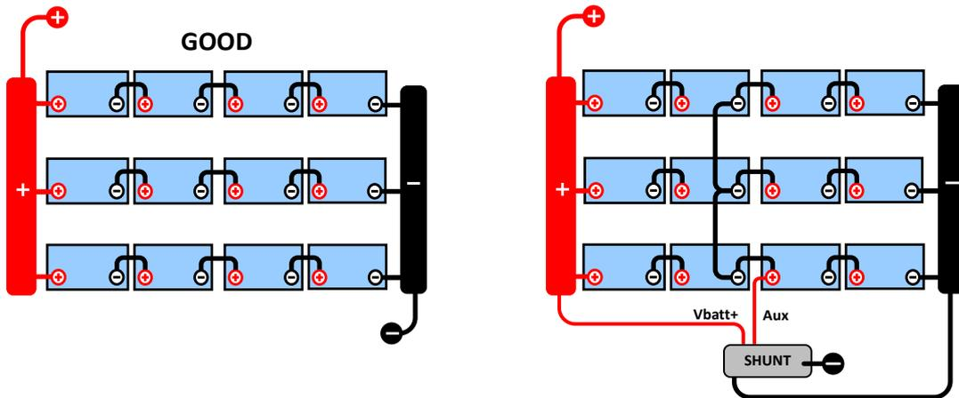
Dans le cas d'un banc de batteries non supervisé, les points médians ne devraient pas être connectés entre eux : un mauvais banc de batteries peut passer inaperçu et endommager toutes les autres batteries.
