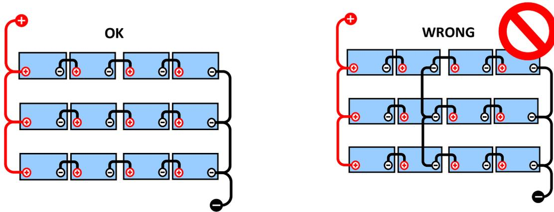
Door de spanningsval in de positieve en de nulcabels is de middenpuntsspanning niet identiek.
