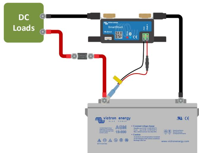
Bitte beachten Sie, dass bei Verwendung des Temperatursensors die roten Stromkabel, die mit dem SmartShunt geliefert wurden, nicht benötigt werden. Der Temperatursensor wird diese Kabel ersetzen.
