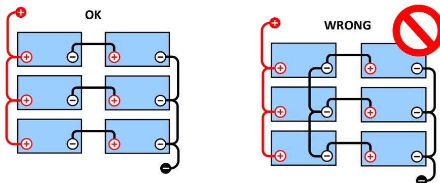
Debido a la caída de tensión en los cables positivo y negativo, las tensiones del punto medio no son idénticas.
