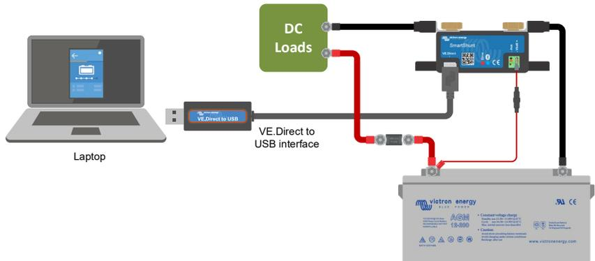
Per collegarsi tramite USB, sarà necessaria una "Interfaccia VE.Direct a USB", numero di serie SS030530000.
