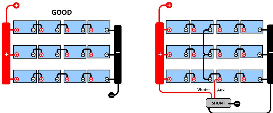
Bij een niet-gemonitorde accubank mogen de middelpunten niet met elkaar verbonden worden. Een defecte accubank kan onopgemerkt blijven en kan alle andere accu's beschadigen.
