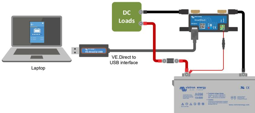
Für den Anschluss über USB benötigen Sie eine „VE.Direct to USB-Schnittstelle“, Teilenummer
