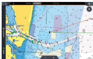
→ **Hinweis:** Bei inaktivem Cursor wird der Wegpunkt an der Schiffsposition erstellt. Bei aktivem Cursor an dessen Position.
